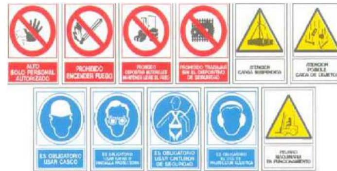
SEÑALIZACIÓN GENERAL DE OBRA
